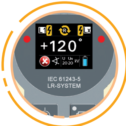
Präzise Phasenwinkelmessung mit Drehfeldanzeige
